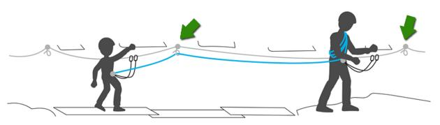
Asegurar con paso de la cuerda por las colas de cerdo. Si no hay colas de cerdo, coloque una cinta exprés delante de cada anclaje. La utilización de los elementos de amarre es esencial para evitar un péndulo en caso de caída.
